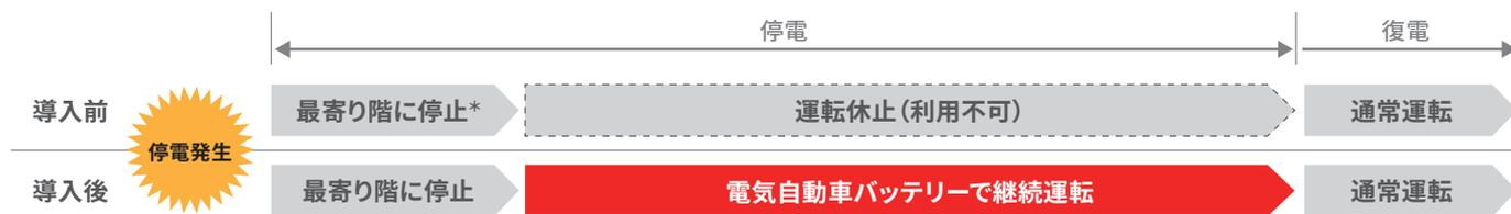
\* 停電時自動着床装置採用の場合。平成21年の建築基準法施行令改正により、閉じ込め防止策として予備電源設置が義務化されました。
